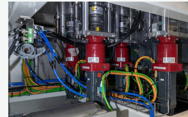
Les machines à mouvement continu sont généralement basées sur un servomoteur central entraînant les roues et vis grâce à des engrenages et des cames.
